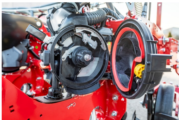
Abbildung 1 Geöffneter AirSpeed Dosierer mit Kornzulaufschieber, Vereinzeler sowie Dichtung und Reinigungsrad im Deckel
